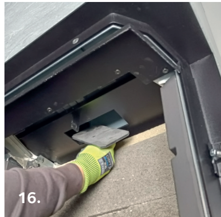
15. 16. 17. Fremste baffelplate og feieluke skal fjernes fra overdelen av ildsted. Merk! Siera er utstyrt med en låseklips som må åpnes. Front- og bakkkanaler på ildsted skal feies gjennom feieluken.
